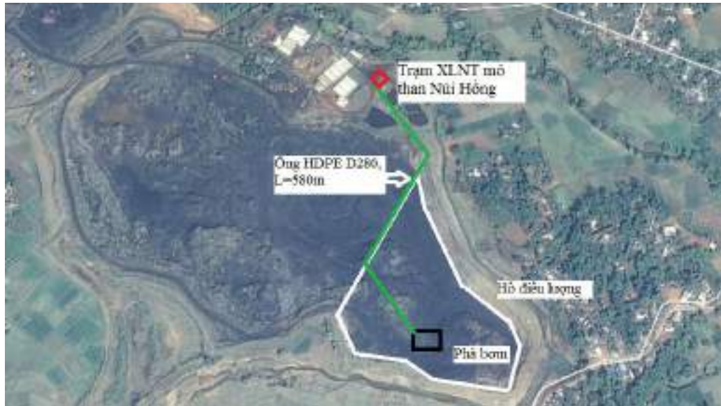
Hình 3.6. Bản đồ thu gom nước thải mỏ than Núi Hồng về trạm xử lý
